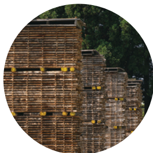
資材工場には天然乾燥中の 板材が積みあがっている
