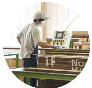
入荷した板材を目視で確認し、 適材適所に仕分ける選別工程
